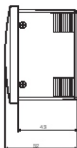
Zdalny panel operatorski do zabudowy tablicowej (opcjonalnie lub jako wyposażenie dodatkowe); wymiary w mm
