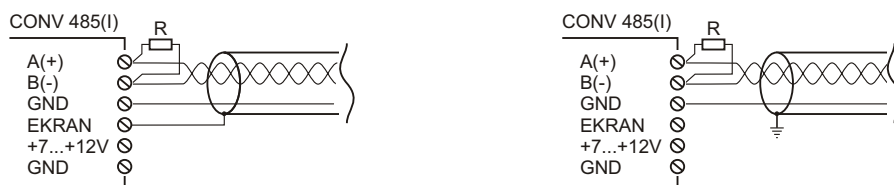
Rys. Podłączenie konwertera CONV 485 / CONV 485I do linii typu para skręcana w ekranie.
