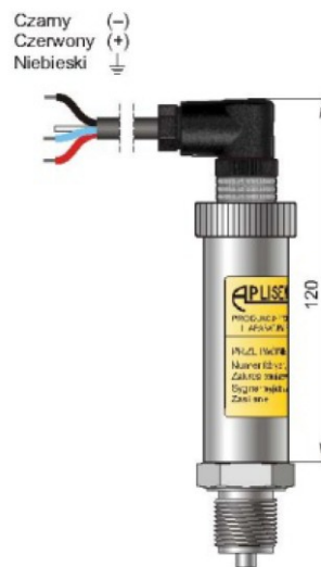
Przetwornik PC-28 z przyłączem elektrycznym typu PM12 Stopień ochrony obudowy IP-67 Kątowe złącze elektryczne M12x1. Połączenie z atmosferą przez kapilarę znajdującą się w kablu, długość kabla 3 m (inna długość kabla – na zamówienie)
