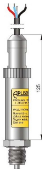
Przetwornik PC-28 z przyłączem elektrycznym typu PK Stopień ochrony obudowy IP-67 Przyłącze elektryczne kablowe, połączenie z atmosferą przez kapilarę znajdującą się w kablu, długość kabla 3 m (inna długość kabla – na zamówienie)
